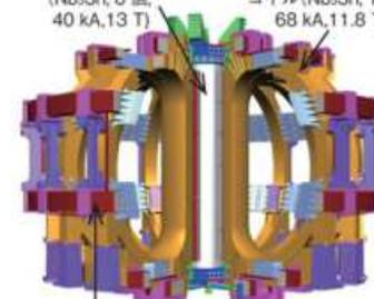
ポロイダル磁場(PF)コイル (NbTi, 6個, 45 kA, 4 ~ 6 T)
