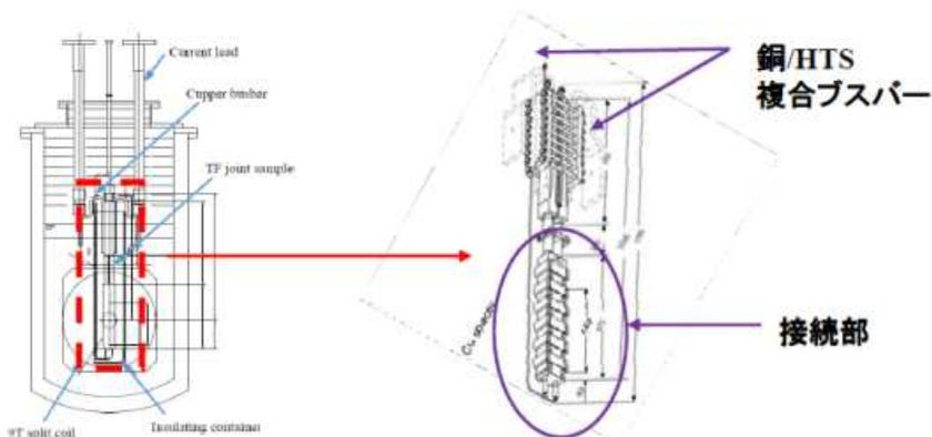
クライオスタット中のITERトロイダルコイルの接続部の試験体
